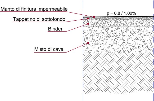
Particolare pacchetto di posa pavimentazione Scala 1:20
